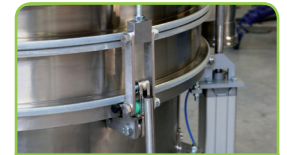
Schnellspanner zum einfachen Siebwechsel
